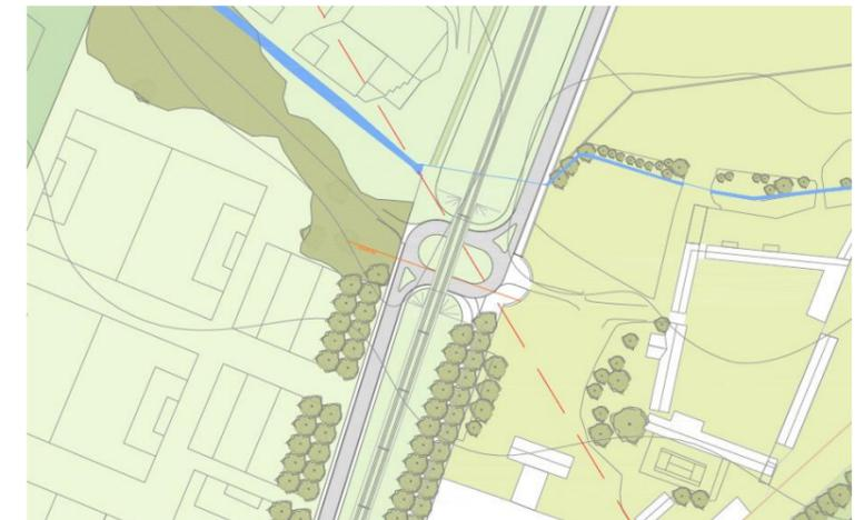
Figure 49 : Carrefour de type ovoïde sous la plateforme de la TGO
